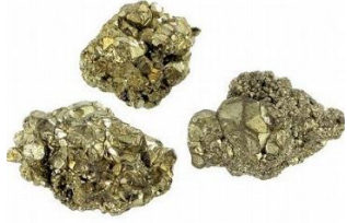
รูปที่ 2 ลักษณะของผลึกแร่ไพไรต์อยู่รวมกัน (ขอขอบคุณ ภาพจาก www.armlady.com)
